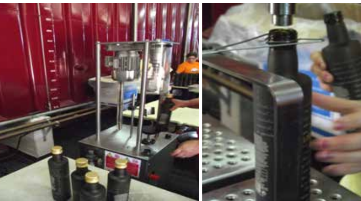
Figura 11. Proceso de embotellado del aceite de oliva.
