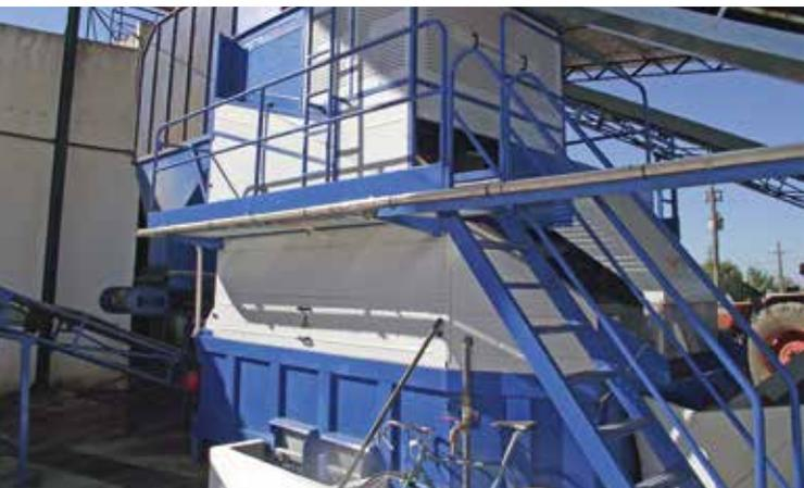
**Figura 4.** Máquina de limpeza e lavagem das azeitonas
