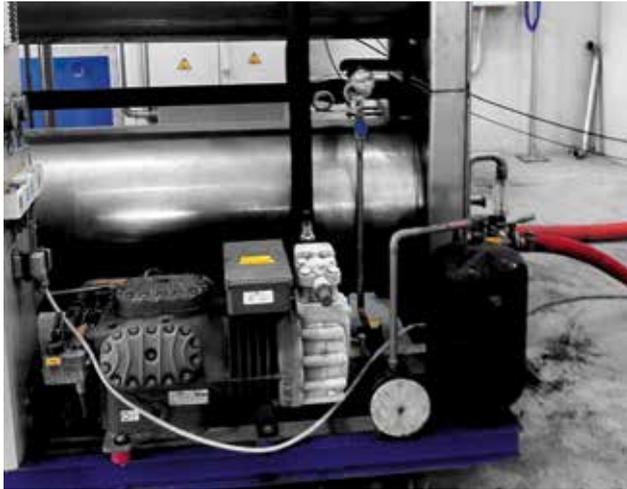
**Figura 5.** Equipamiento de frío para estabilización.
