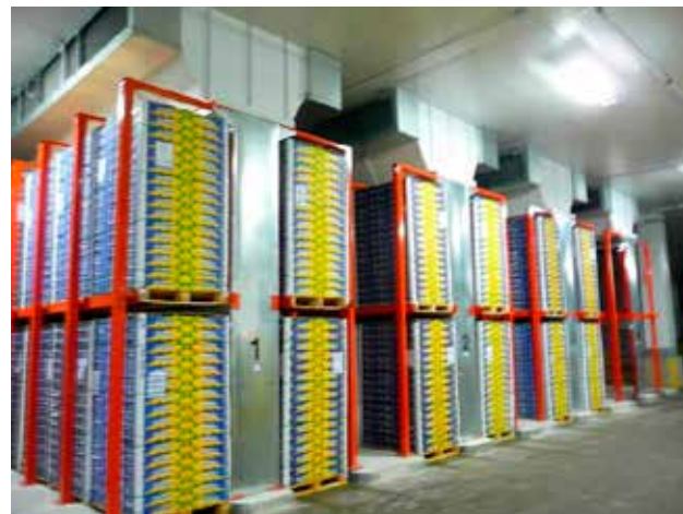
Figura 4. Pre-enfriadoras de aire verticales que reducen el tiempo de preenfriado, lo cual aumenta la calidad y vida útil de las frutas y hortalizas y ahorra costes de energía.
