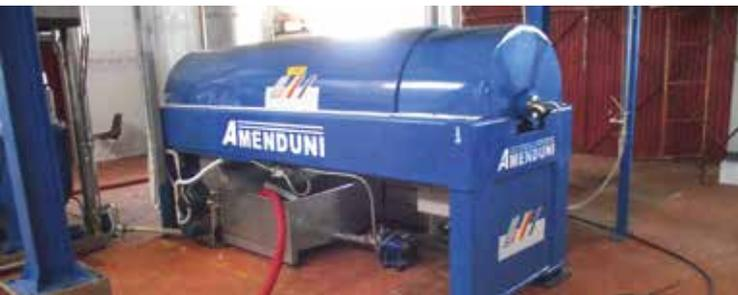
Figure 7. Centrifugeuse horizontale (décanteur)
