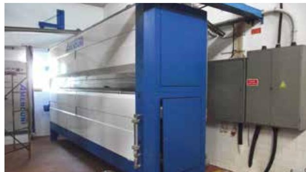
**Figure 6. Mélangeuse horizontale**
