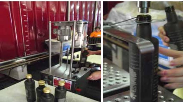
Figure 11. Procédé de mise en bouteille de l'huile d'olives
