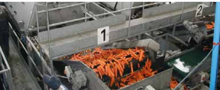
Figura 7. Equipamento de lavagem e classificação.
