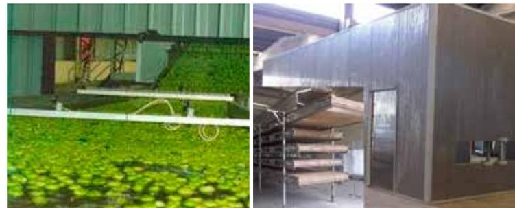
**Figure 6.** Déversement d'eau sur des pommes (à gauche) et un tunnel utilisé pour le séchage (à droite).
